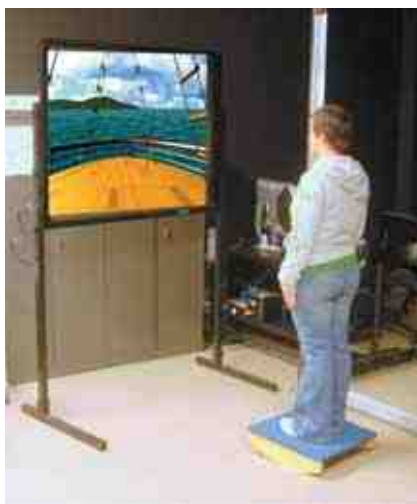
Рис. 7.1. Испытуемый, стоящий на подвижной опоре и наблюдающий движение лодки на экране, ощущает себя стоящим на реальной палубе
