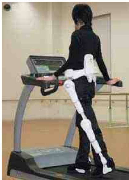
Рис. 8.19. Тестирование HAL-3 на беговой дорожке
