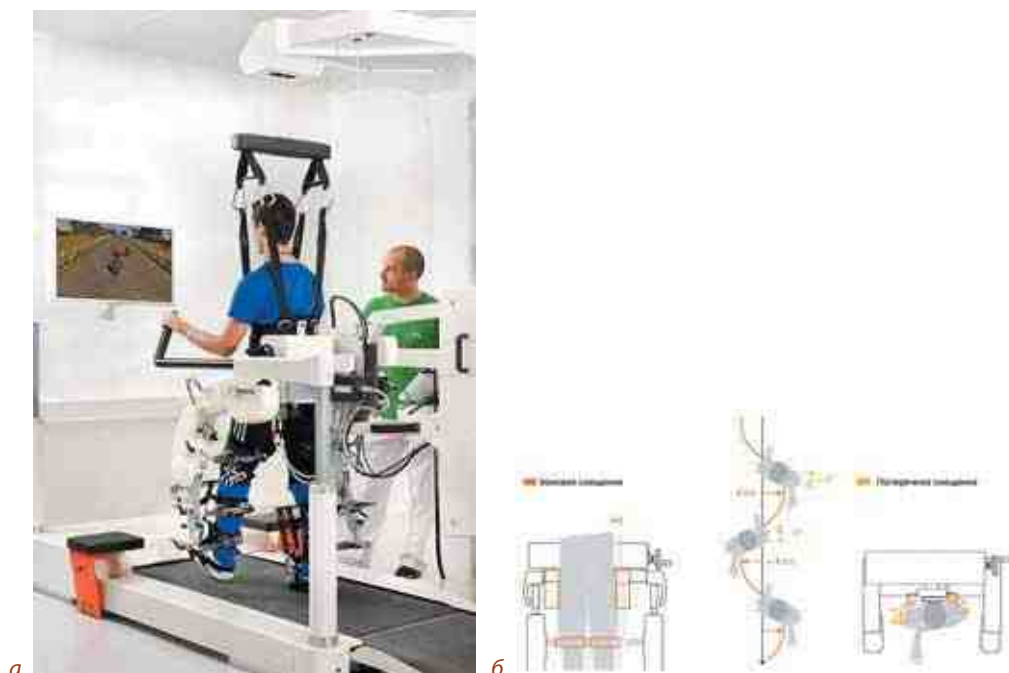
Рис. 8.24. Роботизированный реабилитационный комплекс Lokomat FreeD: а — общий вид тренировки; б — схема ротационных движений таза комплекса Lokomat FreeD
