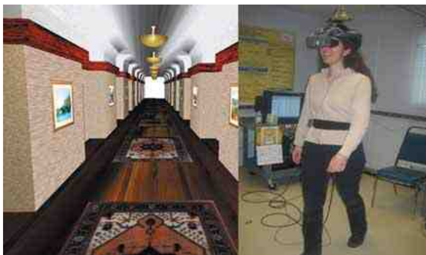
Рис. 7.3. Шлем с вмонтированными дисплеями для проекции виртуального коридора. Модель ProViewTM XL35, выпускаемая компанией Rockwell Collins ( http://www.rockwellcollins.com )
