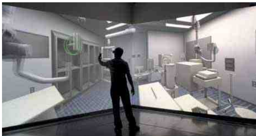
Рис. 7.2. Комната с проецируемыми на стены и пол изображениями виртуального пространства CAVE. Разработана в реабилитационном институте Университета Иллинойса, Чикаго
