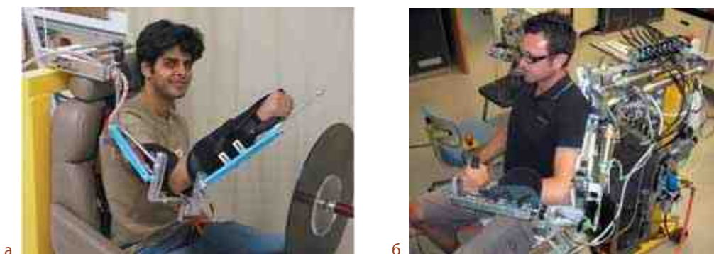
Рис. 8.11. Экзоскелет с функцией механической разгрузки веса руки T-WREX (а) и роботизированный экзоскелет PNEU-WREX (б)
