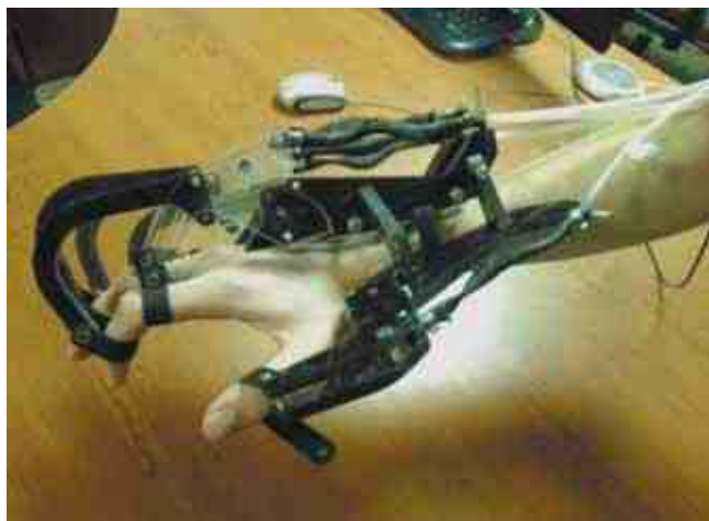
Рис. 9.4. Экзоскелет, разгибающий кисть и пальцы руки при распознавании системой ИМК сигналов активности мозга, соответствующих воображению данного движения (разработчик — ООО «Нейроботикс», Москва, Зеленоград)
